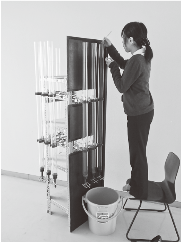
図5. 沈降管の写真. アンクルには9本の沈降管が固定されている. 沈降する殻や粒子を見やすくするために黒板がセットされている.
