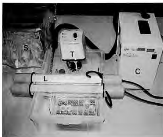
図3. 飼育実験装置。恒温装置は、温度調節装置 (T)、冷却器 (C) および照明装置 (L) からなる。夜間は、覆い (S) で暗環境をつくる。
