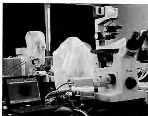
図2. 倒立顕微鏡。CCDカメラを介して、デジタルビデオ装置およびパソコンに接続されている。
