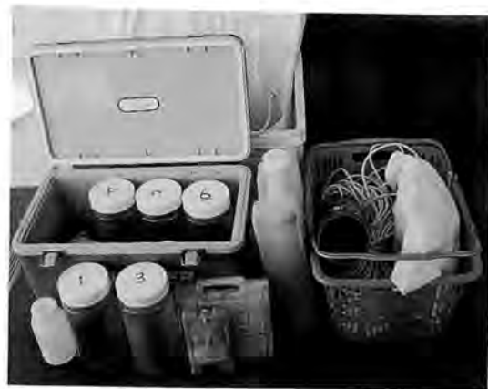
図4. 試料採取用具。プランクトンネット、海水用タンクおよびクーラーボックスなどを試料採取にもっていく。クーラーボックスのなかに、サンプル用容器、冷却剤を入れる。
